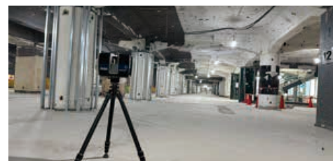
レーザースキャナによる測量
