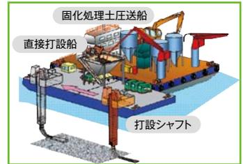
直接打設 (水中) と直接打設 (気中) は、平坦な場所や緩やかな斜面で、護岸と接する部分 (気中) や、海中の部分 (水中) を直接打設船で施工するもので、この打設船により、船に取り付けられた角柱状の打設シャフトの上部から固化処理土を流し込み、ところてんのように押し出して打設しました。
