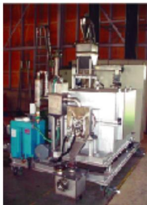
外熱式還元炉(薬剤によるダイオキシン類の加熱無害化処理)
