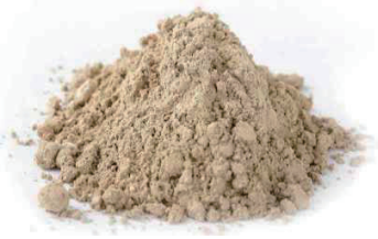
吸水性泥土改質材「ワトル」 (基材はペーパーラスラッジ焼却灰)
