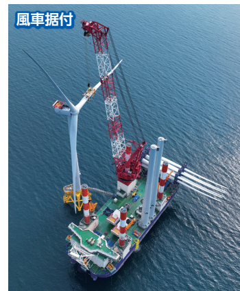
SEP型多目的起重機船 CP-16001(1,600 t 吊)
