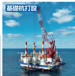
SEP型多目的起重機船 CP-16001(1,600 t 吊)
