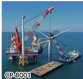
日本初の大型SEP型多目的起重機船
