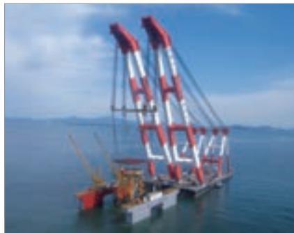
大型起重機船による支持構造物の据付
