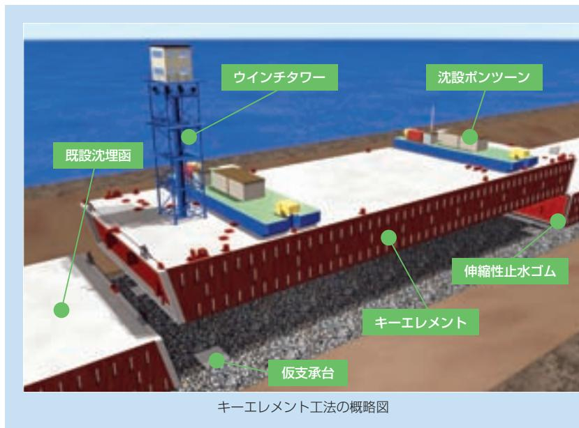
今回の受賞対象となりました「キーエレメント工法」は、海底トンネルの一つである沈埋トンネルの最終継手部分を省略する技術です。従来工法と比べ、最終継手の製作・沈設工が省略できるため大幅なコスト削減と工期短縮を実現します。また、沈設の際に大型起重機船などの設備が不要なため、航路の専有面積が縮小でき、空港制限区域においても施工ができます。さらに、潜土工の作業も軽減できることから、施工の安全性が向上します。
