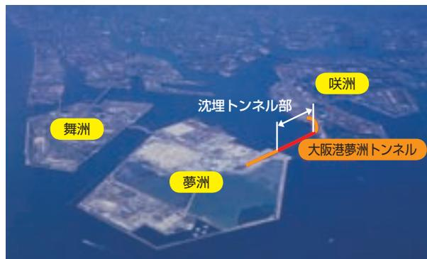
大阪港夢洲トンネルは、完成後も船舶の航行に影響がなく、工事費を削減できる沈埋トンネル方式で計画されました。沈埋トンネル工法は、陸上で巨大な沈埋函（鋼製の殻と鉄筋コンクリートで製作した函体、長さ約100m×幅35.4m×高さ8.6m）を製作し、これを海底に沈設して、つなぎ、トンネルを作る工法です。当社は、8つの函体のうち、2号函の製作、ならびに7号函（最終沈埋函）・8号函の築造工事を行いました。
