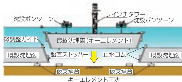
キーエレメント工法では、端部が傾斜した逆台形状の沈埋函を既設函の間に設置した後、接合部の水を排水します。これによって発生する下向き大きな水圧を利用して、最終沈埋函をさらに下に押し込み、接合端部に配置した止水ゴムを圧縮・密着させて、止水を行うことができました。
