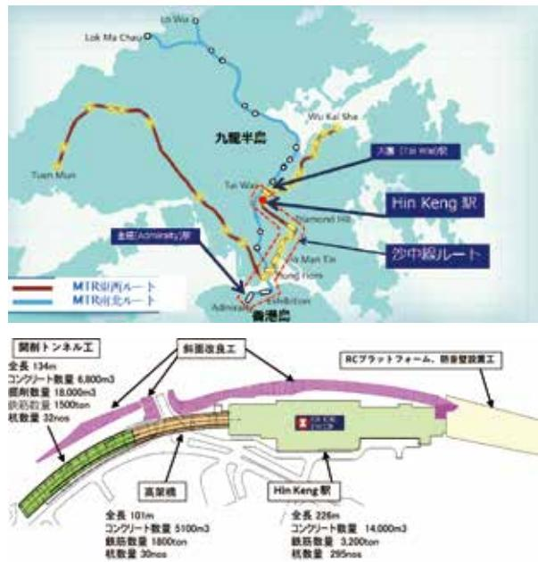
MTR シャーティン・セントラル線は「大圍(Tai Wai)」と「金鐘(Admiralty)」の間を結ぶ全長約17kmの路線。上の図は、MTR のうちシャーティン・セントラル線につながる路線の経路。ヒンキン駅のある北側は東西ルートに、香港島に至る南側は南北ルートにつながる。下の図は、ヒンキン駅舎の建設に伴う主な工事の内容。駅舎建設のほか、高架橋建設、開削トンネル工、斜面改良工などの工事が含まれる、建築・土木の部門間連携が欠かせないプロジェクトである
