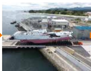
台車をホイールローダーでけん引し、船台に引き入れる
