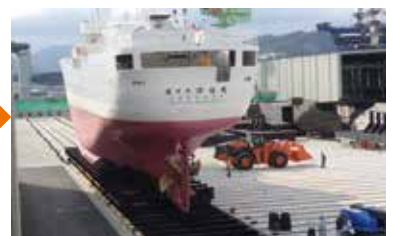
縦方向用の縦移動台車を残し、その上に重ねた横移動台車で所定の船台まで横移動する
