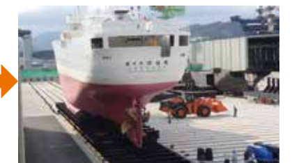
縦方向用の縦移動台車を残し、その上に重ねた横移動台車で所定の船台まで横移動する
