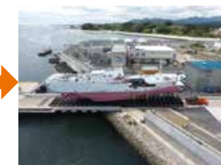
台車をホイールローダーでけん引し、船台に引き入れる
