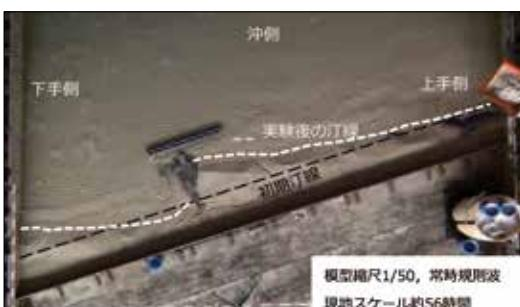
技術研究所の大型平面水槽で実施した堆砂模型実験。沿岸流は、「上手側」と記された方向からL型突堤に向かって流れる。実験後はL型突堤の上手側に堆砂が確認できた
