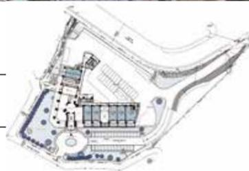
敷地はJR熱海駅前の一角。海拔80mの高台に立つ。南東には太平洋が広がり、マンションのエントランスも海側に設けられている。地下2階から免震層までの低層部3層は既存躯体を利用。その上に高層部を新しく構築した
