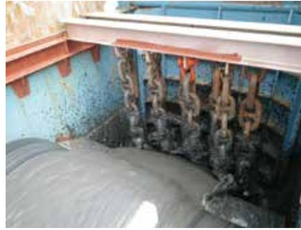
カルシア改質材と浚渫土がベルトコンベアから落ちる瞬間。改質材は慣性でそのまま前方に、浚渫土はその粘りから下方に落ちやすく、落下地点がずれやすい。それでは落下による混合効果が期待できないため、チェーンを用いて流れを1つに整えている
