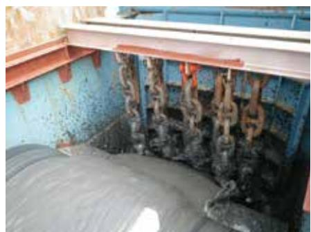
カルシア改質材と浚渫土がベルトコンベアから落ちる瞬間。改質材は慣性でそのまま前方に、浚渫土はその粘りから下方に落ちやすく、落下地点がずれやすい。それでは落下による混合効果が期待できないため、チェーンを用いて流れを1つに整えている
