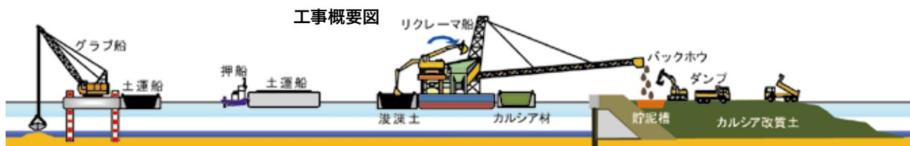
衝突運動量を与えることによって、ベルトコンベアで搬送するカルシア改質材と浚渫土を混ぜ合わせる方式。この現場では、ベルトコンベア乗り継ぎ部で落差2.5mの落下、ベルトコンベアから貯泥槽に入るときにその手前に配置した傾斜板で落差10mの落下による衝撃が加わる。現場条件によっては貯泥槽のカルシア改質土は重ダンプで打設地点に運搬し、そこに流し入れ
