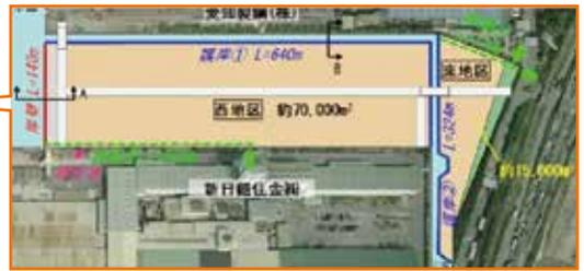
となった体制を構築し、8万5100㎡の埋立地を新技術で造成する事業を開始した。陸側の東地区1万5200㎡の埋立に続き、海側に続く西地区6万9900㎡の埋立を進める中で、カルシア改質土を生み出す方式として落下混合方式を確立し、西地区の埋立を無事に終えたのである。
