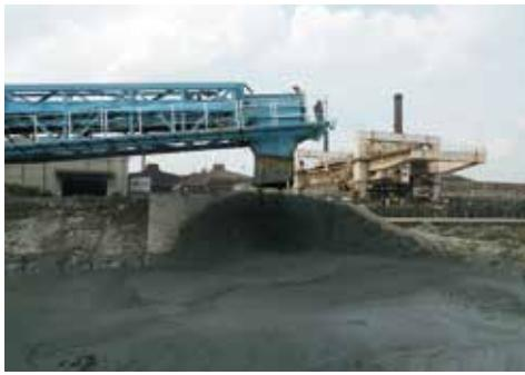
落下混合方式では、ベルトコンベアで運ばれてきたカルシア改質材と浚渫土を落下させることで混ぜ合わせる。それぞれ同じ地点に落ちるよう チェーンで制御したうえで、できるだけ大きな衝撃が加わるように落下地点には傾斜板を設置している
