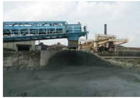
落下混合方式では、ベルトコンベアで運ばれてきたカルシア改質材と浚渫土を落下させることで混ぜ合わせる。それぞれ同じ地点に落ちるようにチェーンで制御したうえで、できるだけ大きな衝撃が加わるように落下地点には傾斜板を設置している
