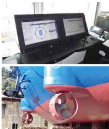
洋上風力発電設備の設置では、作業にあたるSEP船から脚にあたる4本のレグを下ろし、船体を自立させる。ところが、レグが海底に到達する前に潮流や波・風の影響を受けて船体の位置がずれると、レグが折れる危険がある。そこで、「CP-8001」には船体の位置を保つ自動船位保持装置を搭載した。上の写真は、その操作盤。この装置は、潮流や波・風の影響をどの程度受けるのかをセンサーでの測定と計算によって把握したうえで、推進装置であるアジマススラスタを連動させる。アジマススラスタは下の写真のように水平方向に360度回転する推進装置で、船首・船尾の両舷にそれぞれ1基ずつ、合計4基が取り付けられている。自動船位保持装置でアジマススラスタを自動制御し、それによって船体の位置を保つ。
