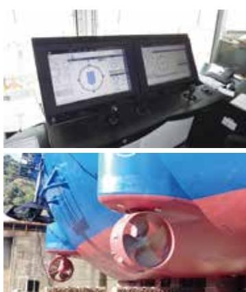
洋上風力発電設備の設置では、作業にあたるSEP船から脚にあたる4本のレグを下ろし、船体を自立させる。ところが、レグが海底に到達する前に潮流や波・風の影響を受けて船体の位置がずれると、レグが折れる危険がある。そこで、「CP-8001」には船体の位置を保つ自動船位保持装置を搭載した。上の写真は、その操作盤。この装置は、潮流や波・風の影響をどの程度受けられるのかをセンサーでの測定と計算によって把握したうえで、推進装置であるアジマススラスターを連動させる。アジマススラスターは下の写真のように水平方向に360度回転する推進装置で、船首・船尾の両舷にそれぞれ1基ずつ、合計4基が取り付けられている。自動船位保持装置でアジマススラスターを自動制御し、それによって船体の位置を保つ。
