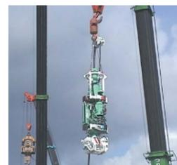
●煙突除染ロボット「ペンタクロス」1号機
