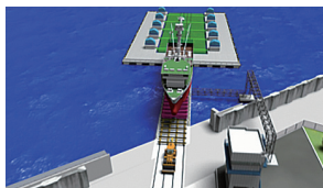
③牽引車で防潮堤内の作業ヤードに船舶を引き込む
