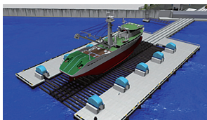
②あらかじめ海中に沈めておいたプラットフォームに船舶を載せ垂直に上昇させる
