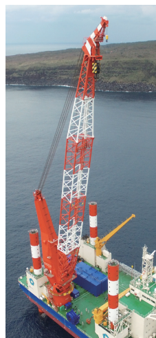
①800t吊全旋回クレーン
