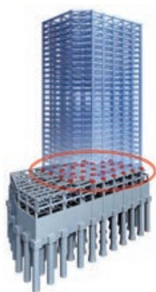
中間免震構造とは、建物の中間階に高減衰積層ゴム、オイルダンパーなどの免震装置を設置する構造です。(左図赤色部分)
