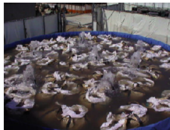
煉瓦浸漬処理状況
